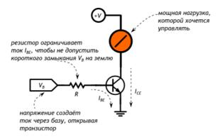
Транзистор усиливает максимально допустимый ток в  $h_{fe}$  раз:
