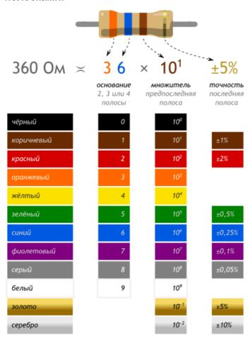
Разные серии резисторов содержат разное количество полос, но принцип расшифровки одинаков.
