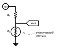
Микроконтроллер умеет измерять напряжение. Таким образом, мы можем использовать свойства делителя напряжения для получения показаний от сенсора.
